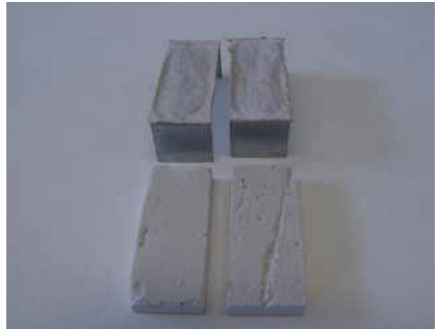
Kartongen rengjord för att limma på en dragbit så limning till stål kan testas.
