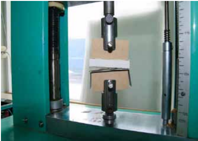
Test av limning mellan gipskarton och plåt, plåten inte rengjord från dragvätska. Höger bild visar att brottet till viss del sker i gipskärnan.
