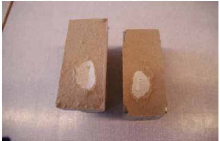
Test av limning mellan gipskarton och plåt, plåten inte rengjord från dragvätska. Höger bild visar att brottet till viss del sker i gipskärnan.
