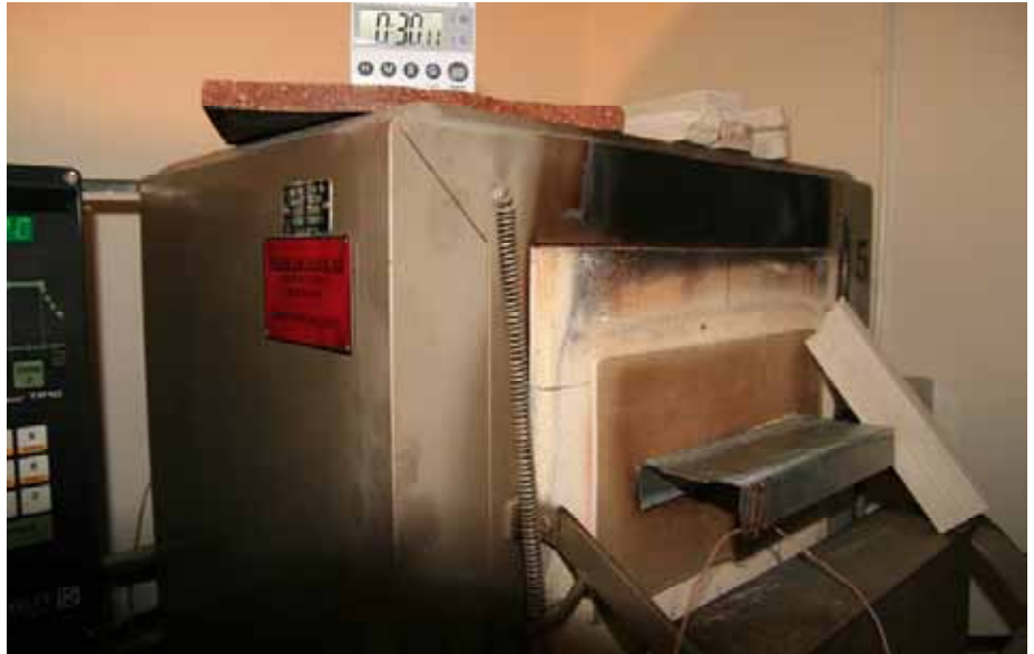
Magna-limmad skiva efter 30 minuters testtid. Skivan missfärgad av ugnsvärme på baksida. Men regeln sitter hårt fast i skivan.
