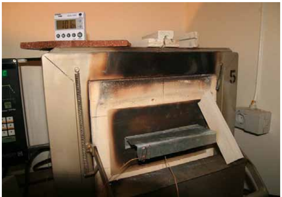
Magna-limmad skiva efter 66 minuters testtid. Skivan kraftigt missfärgad av ugnsvärmen på basida. Men regel sitter hårt fast i skivan.
