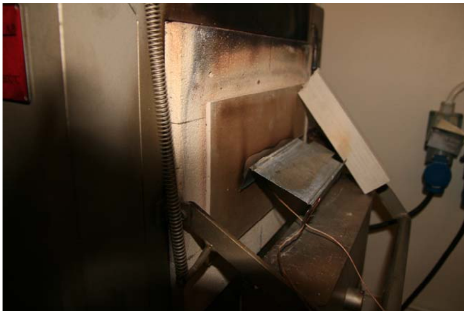
Limmad med Montagelim. Bilden visar utseende efter 30 minuter men regeln släppte redan efter 6 minuter.
